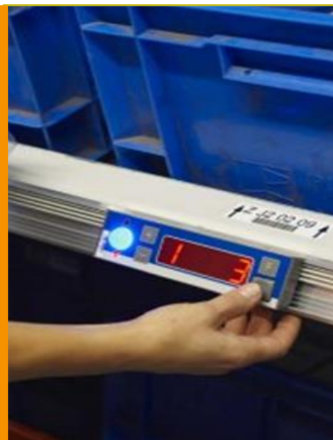
電子燈號 揀貨系統 DLP (Digital Light Picking System ) 【 Person-to-goods 】
