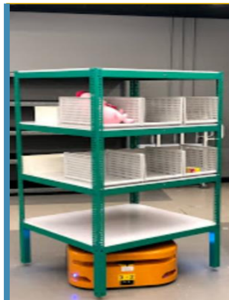
無人車智能 揀貨系統 AGV Picking System 【 Goods-to-person 】
